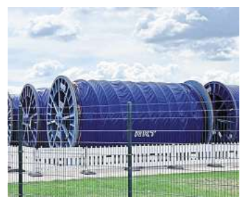
Mächtig: Die Kabeltrommeln wiegen je 100 Tonnen und tragen rund zwei Kilometer Kabel. Foto: Kathrin Götzte
