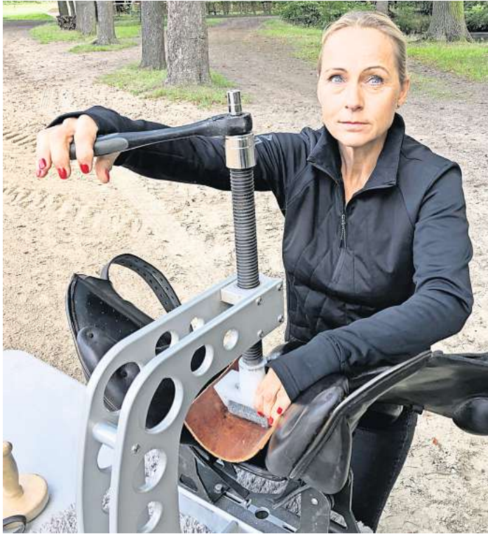
Anpassung: Durch das Drehen der Handkurbel an der Baumeinstellmaschine wird das Kopfeisen des Sattels eingestellt.
